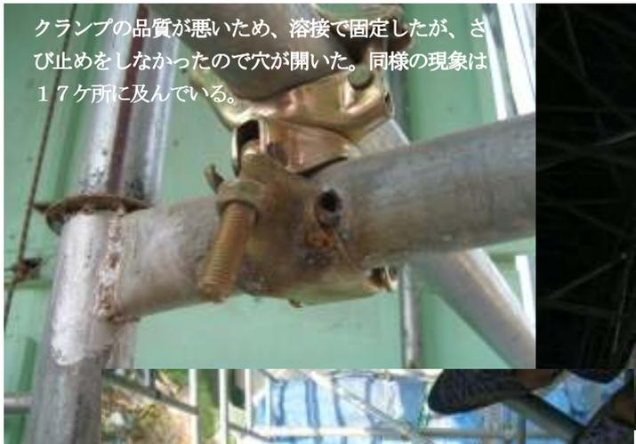
クランプの品質が悪いため、溶接で固定したが、さび止めをしなかったので穴が開いた。同様の現象は17ヶ所に及んでいる。
